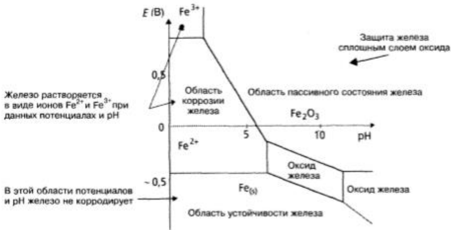
Рис. 12.4. Упрощенная диаграмма потенциал-pH железа. C_{\text{Fe}} = 10^{-6} моль/л
